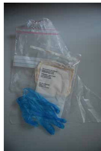
ABBILDUNG 3: Probennahmeset der Fa. SodiBox, bestehend aus je einem Paar Kunststoffüberziehtiefeln, Gaze Tupfer, Einweghandschuhe und einem Kunststoffbeutel (Foto: AGES Tiergesundheit)
